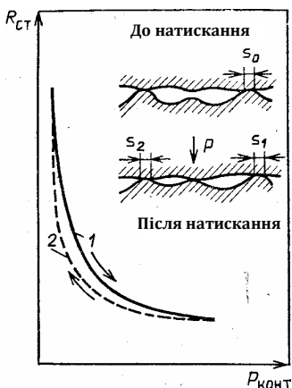
Рис. 3.3 – Залежність перехідного опору від контактного натискання
