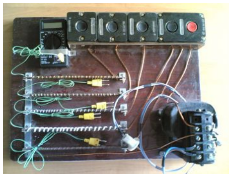
Рис. 2.3 – Загальний вигляд стенда для дослідження нагрівання провідників
